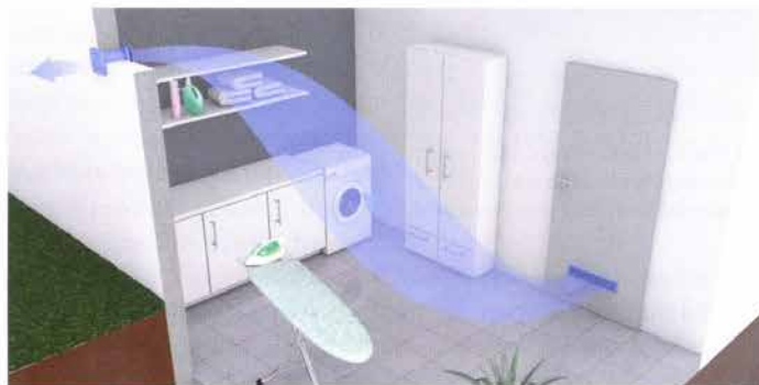
Funktionsdarstellung der Abluftströmung in einer Keller-Waschküche
